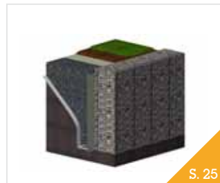
Hinterfüllung von Stützbauwerken
