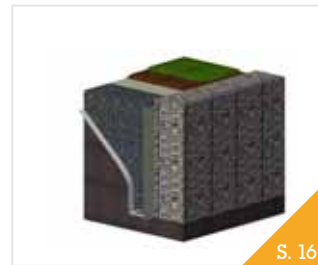
Hinterfüllung von Stützbauwerken
