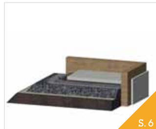
Fußbodenaufbau ohne Bodenplatte
